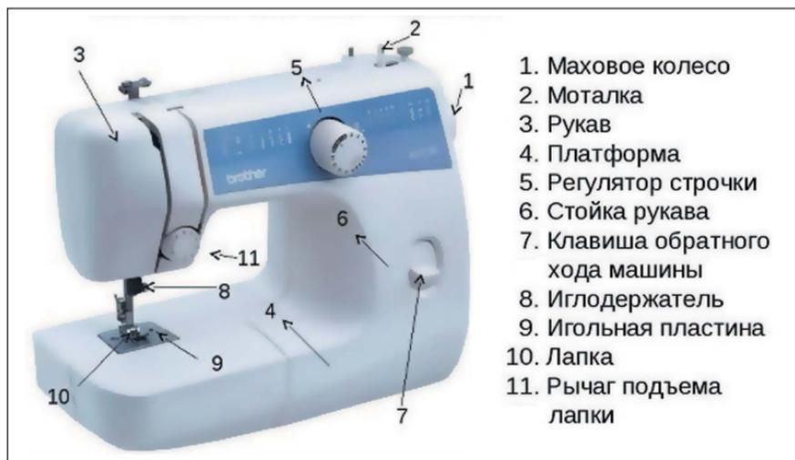
**Схема устройства швейной машины.**
